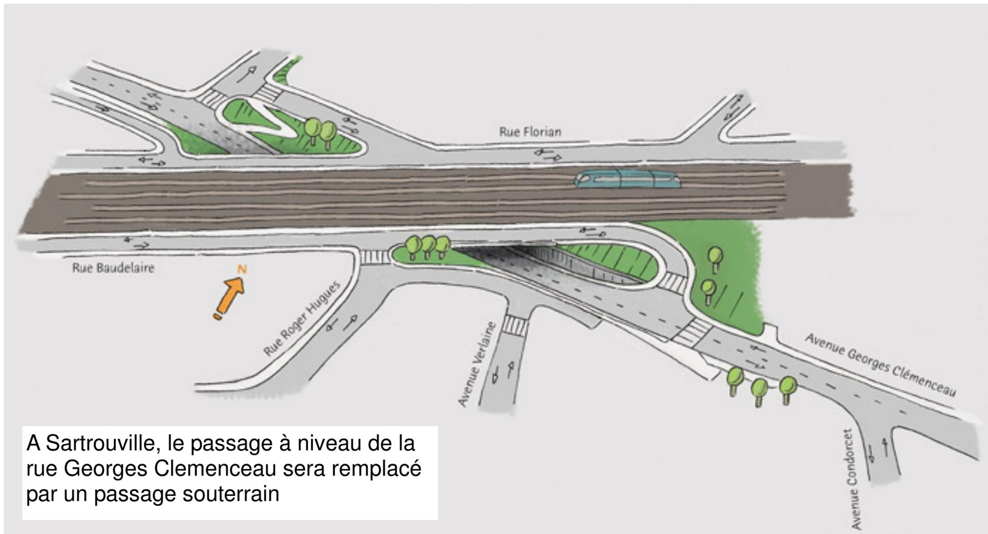
A Sartrouville, le passage à niveau de la rue Georges Clémenceau sera remplacé par un passage souterrain
